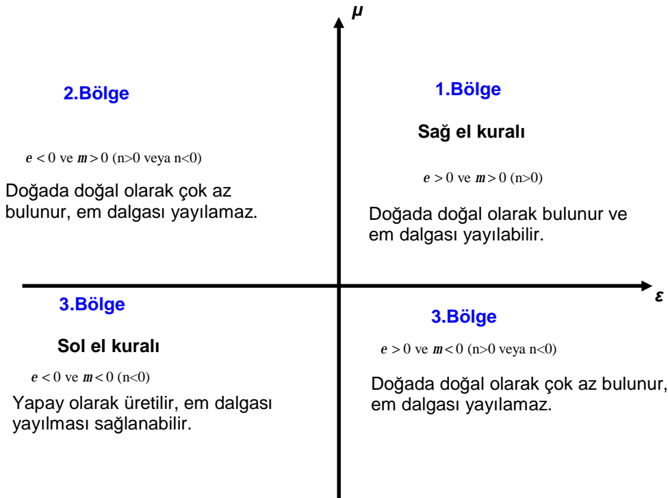
Şekil 1.2. Elektromanyetik malzemelerin sınıflandırılması
