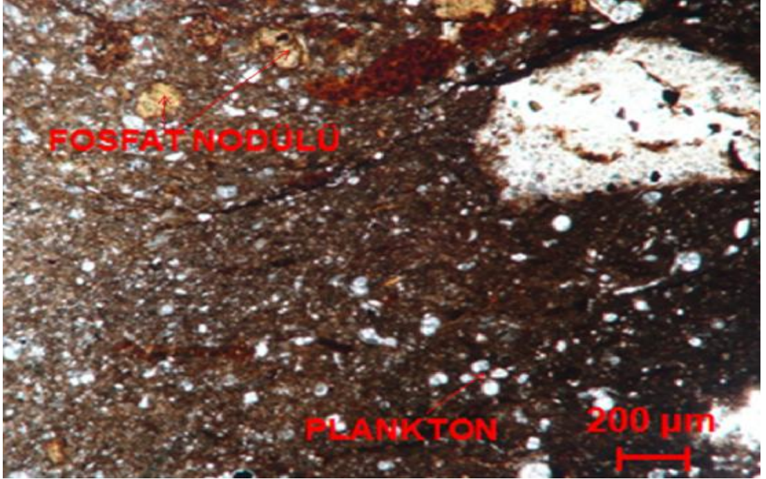
Fotoğraf 5.1. Karaboğaz Formasyonuna ait Vaketaşı'nın mikroskop görüntüsü (Dunham, 1962): Organik maddeli, fosfatlı, planktonik foraminiferli.
