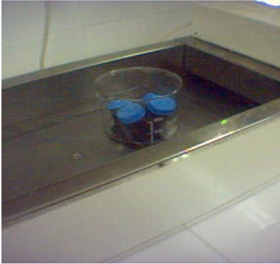
Şekil 3. 2. Kömür örneklerinin 80°C'de 6 saat su banyosunda bekletilmesi
