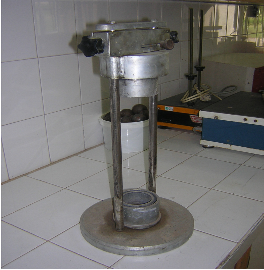
Şekil 3.3. Düzeltilmiş Darbe Dayanım Ölçme Aygıtı (Ural, 1999)
