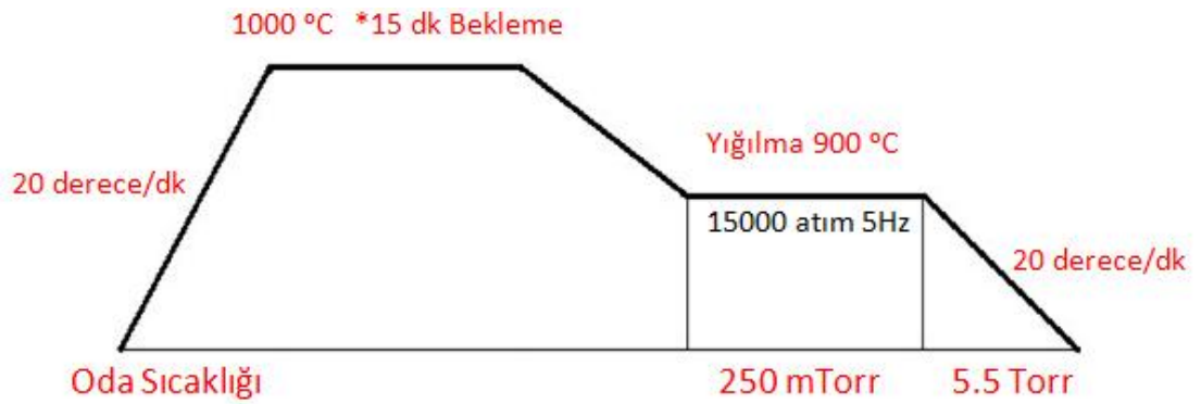
Şekil 4.30. 9 nolu deneme örneğine ait PLD parametreleri.
