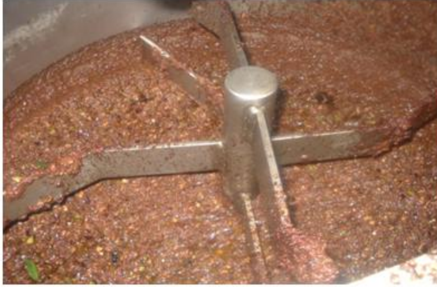
Şekil 3.5. Yağ ekstraksiyon cihazının malaksör kısmı
