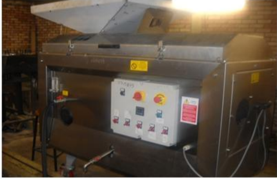
Şekil 3.3. Denemelerde kullanılan iki fazlı dekantör
