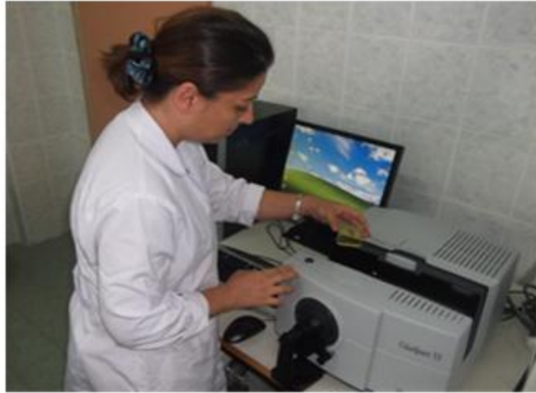
Şekil 3.7. Örneklerin renk analizleri (HunterLab ColorQuest/XE)
