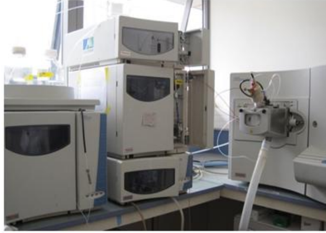
Şekil 3.9. Fenol bileşikleri tanımlamasının yapıldığı HPLC-MS cihazı
