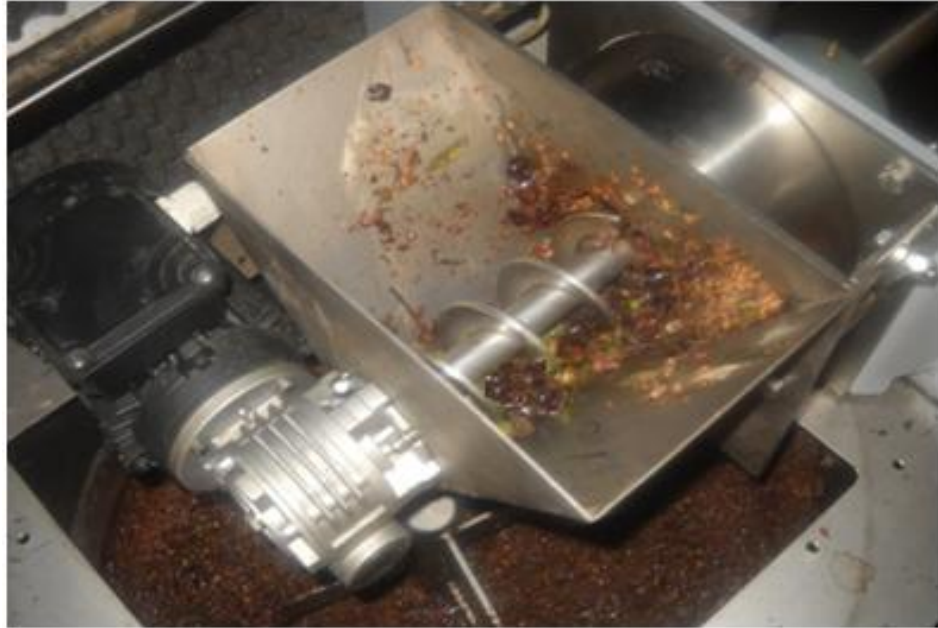
Şekil 3.4. Yağ ekstraksiyon cihazının değirmen kısmı
