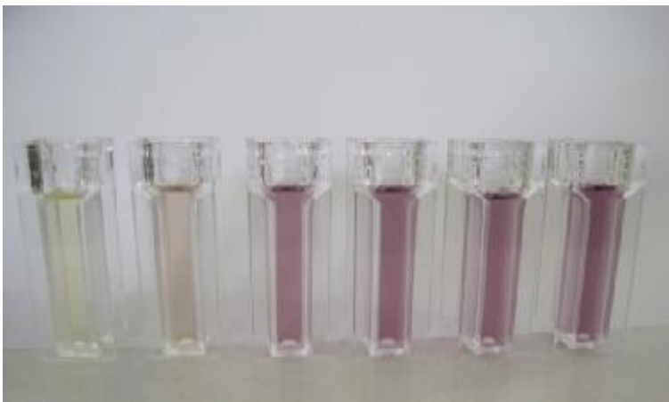
Şekil 4.11. DPPH ile gerçekleşen reaksiyonun zamana karşı değişimi
