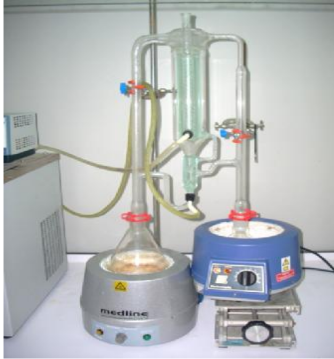
Şekil 3.14. Likens-Nickerson aroma maddeleri ekstraksiyon düzeneği
