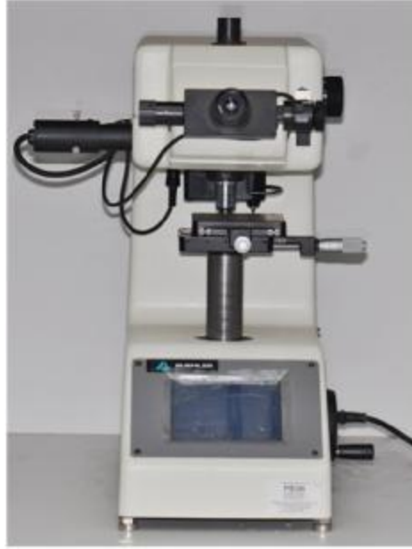
Şekil 3.13. Knoop mikrosertlik testinin uygulandığı test cihazı
