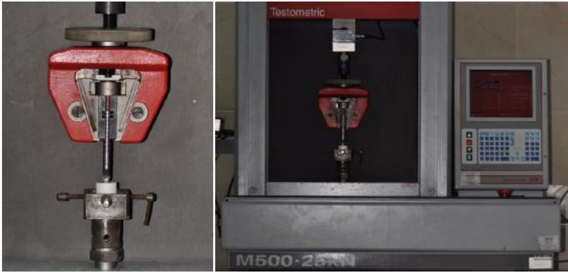
Şekil 3.11 Braketlerin kopartılmasında kullanılan Testometric Cihazı
