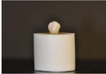
Şekil 3.1. Dişin bukkal yüzeyi borunun uzun aksına paralel olacak şekilde, kendiliğinden sertleşen akril içine yerleştirilmiş küçük azı dişi
