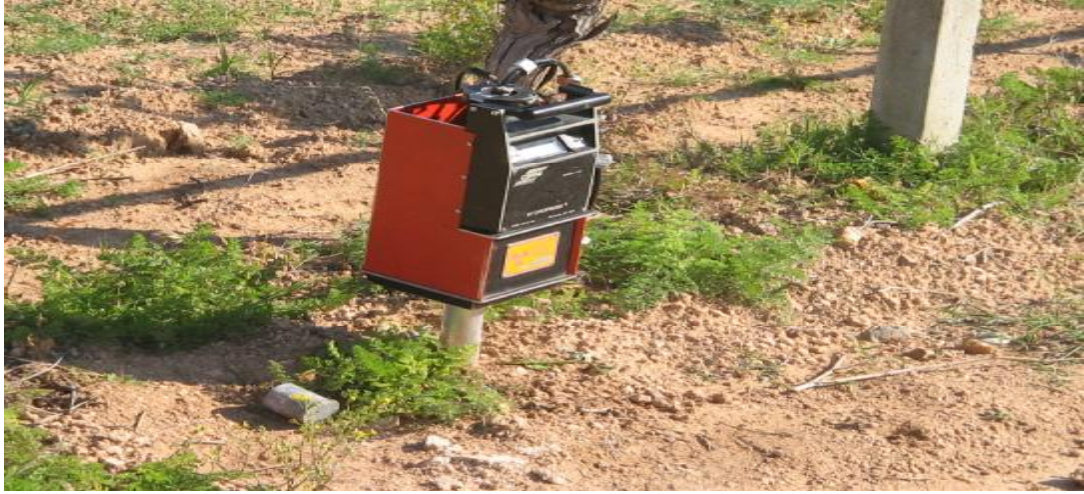
Şekil 3.1. CPN 503 Hydroprobe, DR tipi nötronmetre
