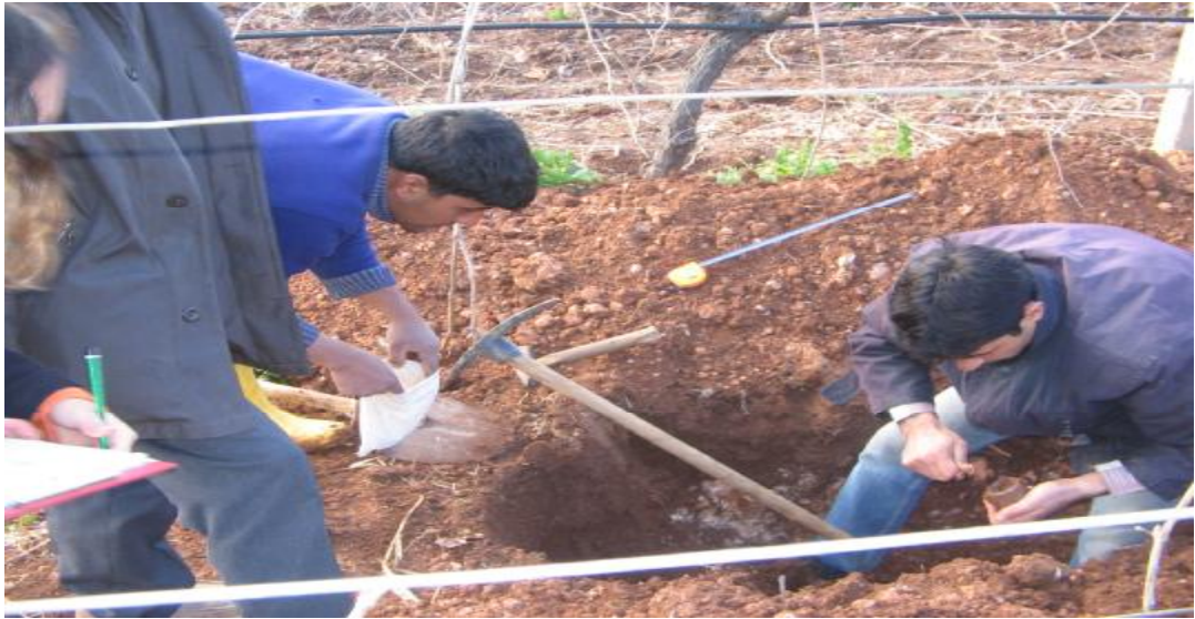
Şekil 3.2. Bozulmuş ve Bozulmamış Toprak Örneklerinin Alınmasına İlişkin Görüntü.
