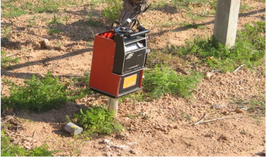
Şekil 3.3. Denemede Kullanılan Nötronmetre ve Giriş Borusuna İlişkin Görüntü
