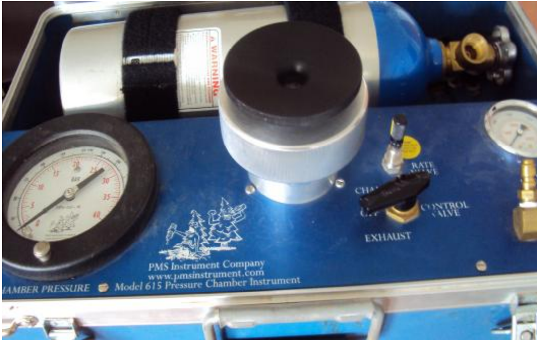
Şekil 3.7. Portatif Basınç Odacıđı (Pressure Chamber) PMS Instrument Company (Model 615) Aygıtına İlişkin Görüntü
