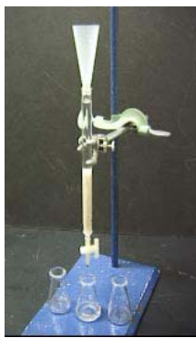
Şekil 3.4. F-SPE tekniği ile yapılan ayırma ve saflaştırma işlemi
