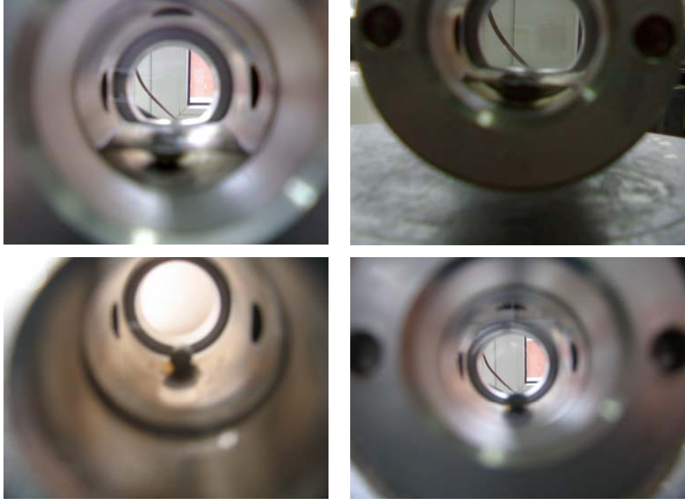
Şekil 4.1. Pencereli yüksek basınç reaktörü içerisinde gerçekleştirilen çözünürlük çalışmalarına ait resimler
