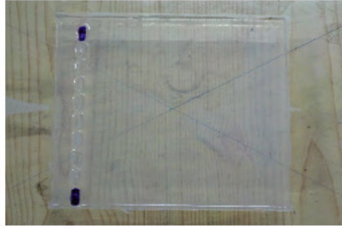
Şekil 12. Agoroz jelin dökülmesi ve bloklara yerleştirilmesi.
