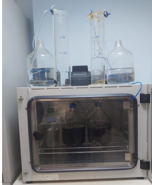
Şekil 3.2. 55°C Sıcaklıkta Enzim Uygulaması Yapılan Anaerob Sistem
