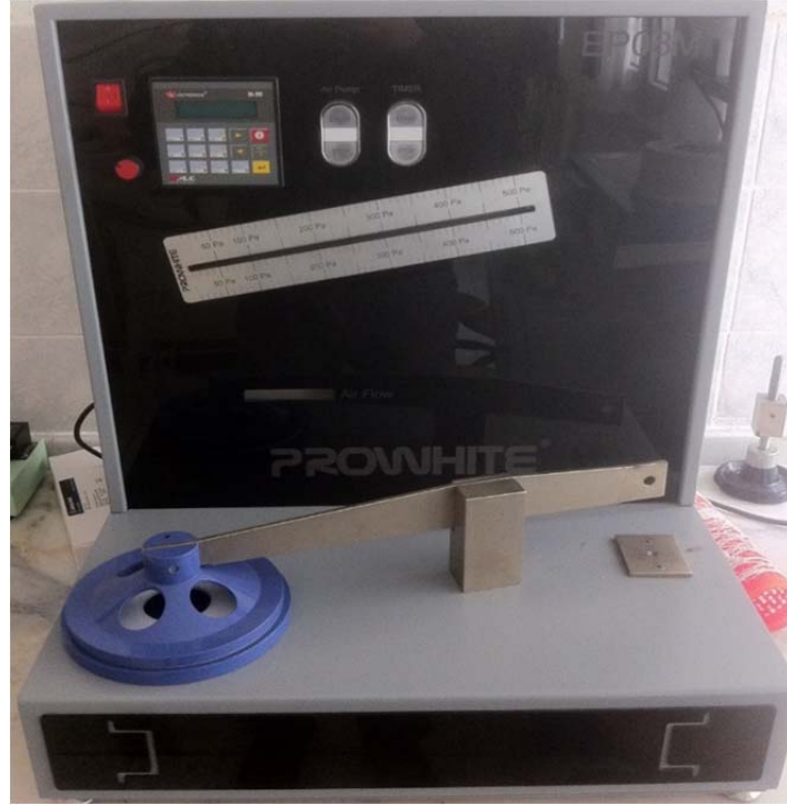
Şekil 5.3. Prowhite hava geçirgenliği test cihazı
