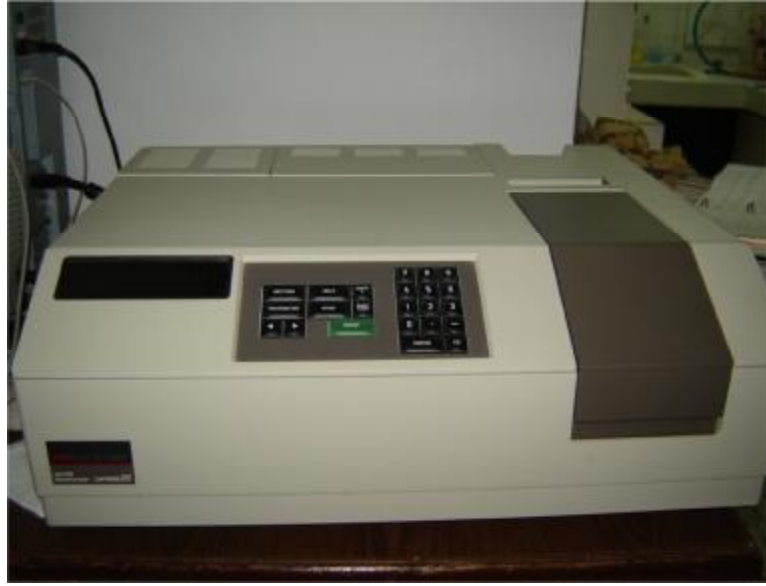
Şekil 3.21. Perkin-Elmer UV/VIS Lamda 2S Spektrometresi
