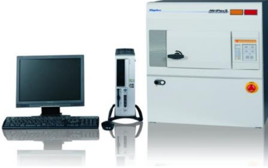
Şekil 3.17. XRD (X Ray Diffraction, X ışınları Kırınımı) cihazı
