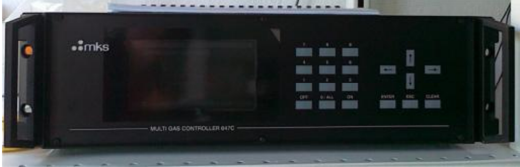
Şekil 3.13. Gaz Akış-Basınç Kontrol Sistemi
