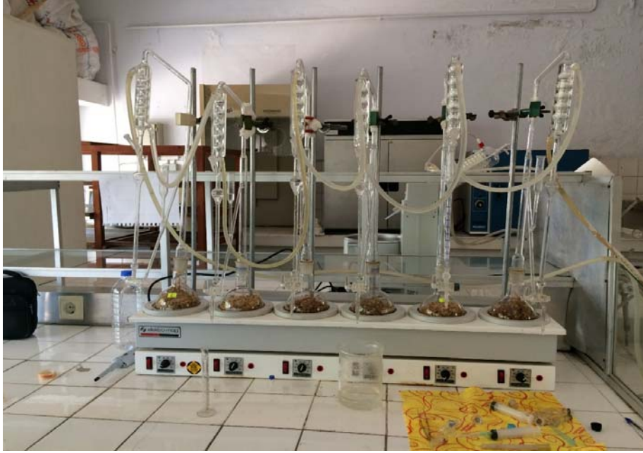
Resim 3.20. Mantolu Isıtıcı 6 Seri Clevenger Düzeneginin Çalışması
