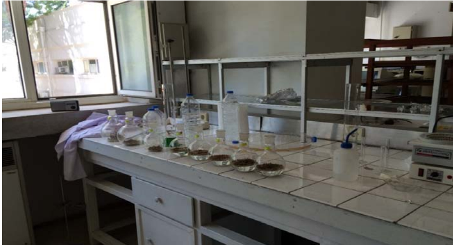
Resim 3.18. Numunelerin Tartılması, Balonlara Konulup Saf Su ile Hazırlandıktan Sonra Analize Başlanması
