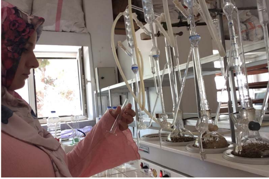
Resim 3.21. Elde edilen Uçucu Yağın Otomatik Kılcal Pipet ile Alınıp Mezürle Hacim Ölçülmesi
