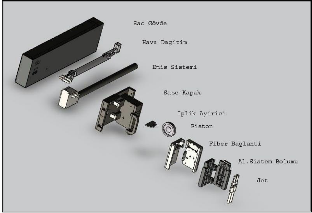
Şekil 3.11. Sıcak hava jetli ve tamburlu tekstre nitesi elemanları
