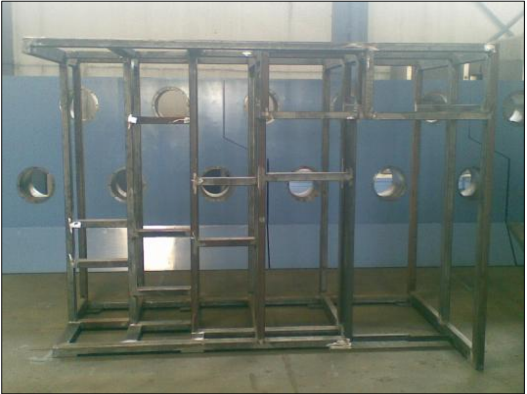
Şekil 3.1. Laboratuvar tipi filament iplik üretim makine şasesi görseli
