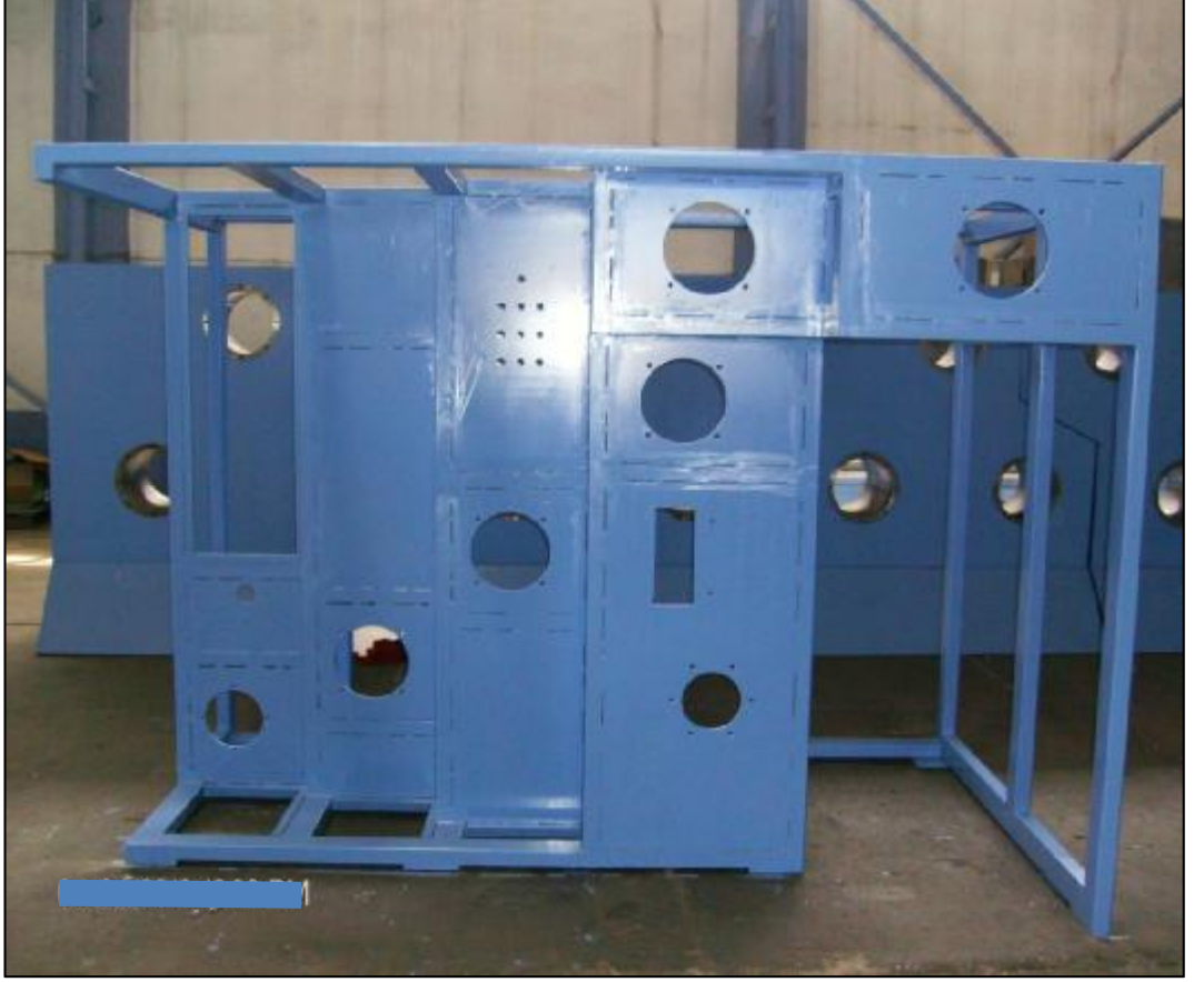
Şekil 3.2. Laboratuvar tipi filament iplik üretim makine boyanmış şase görseli
