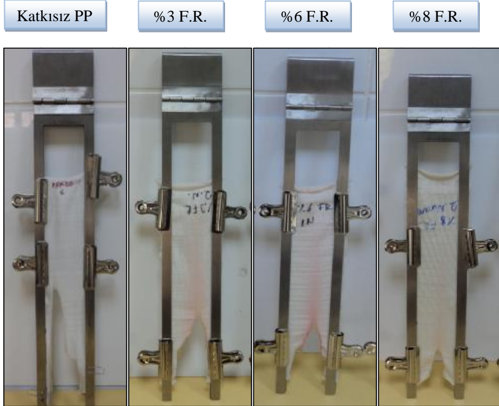
Şekil 4.43. Katkısız PP ve farklı oranlarda F.R. katkı maddesi içeren örme kumaş test numunelerinin yanma uzunlukları
