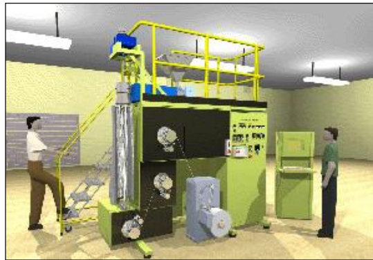
Şekil 1.10. Hills marka fil. iplik üretim makinesi ( http://www.hillsinc.net , 2013)
