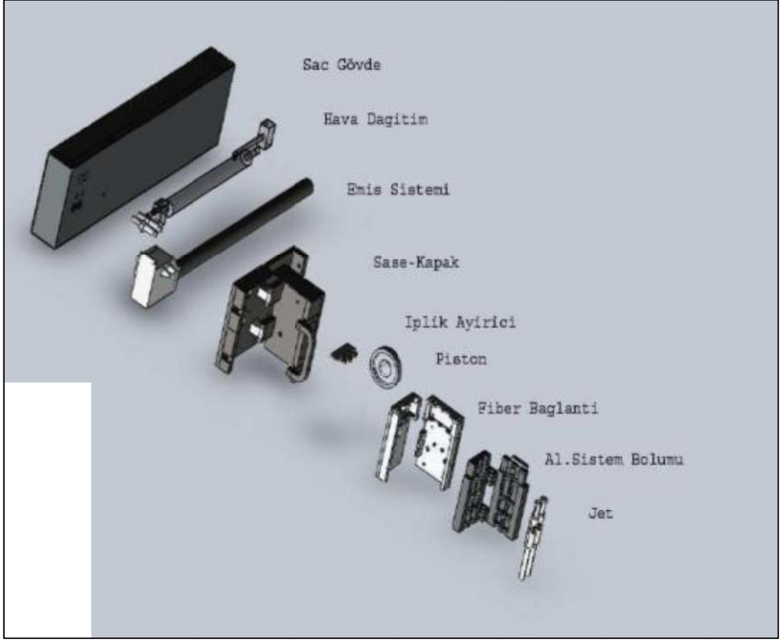
Şekil 2.8. Laboratuvar tipi filament iplik üretim makinesi tekstüre jeti teknik çizimi
