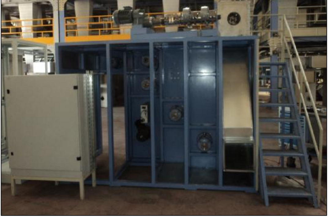
Şekil 3.7. Laboratuvar tipi filament iplik üretim makinesinin arkadan görünüşü
