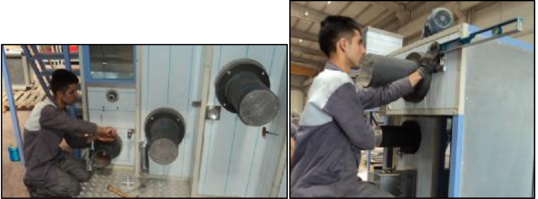
Şekil 4.19. Godetlerin makineye montajı
