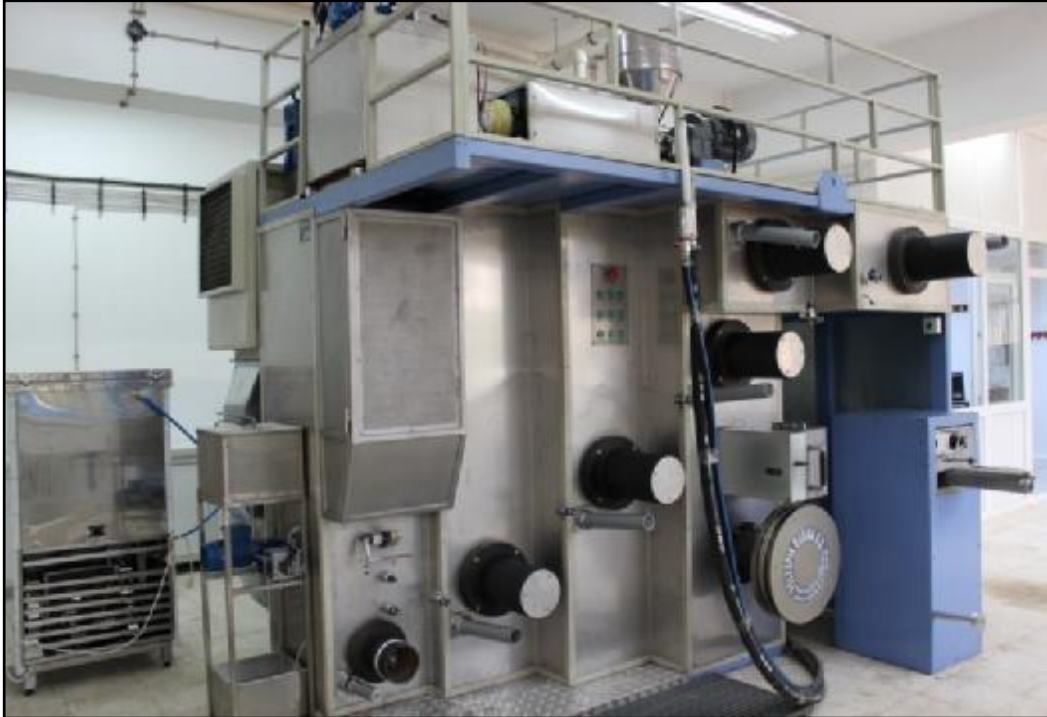
Şekil 3.5. İmalatı gerçekleştirilen laboratuvar tipi filament iplik üretim makinesi
