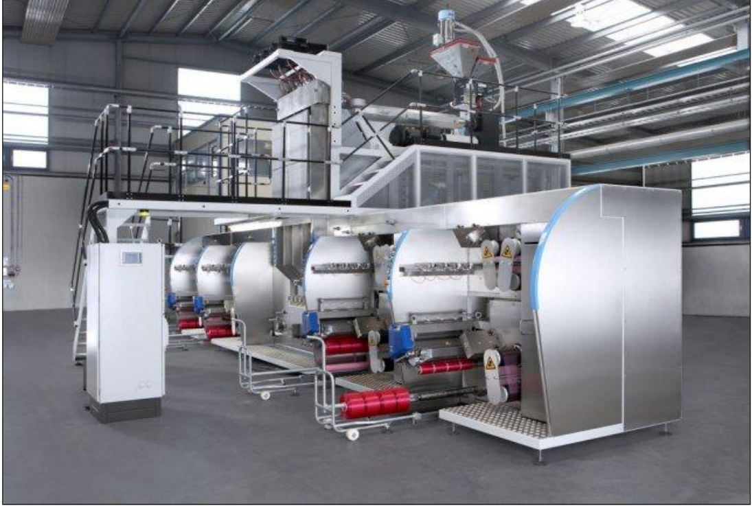
Şekil 1.11. SML marka filament iplik üretim makinesi ( http://www.sml.at/spinning-lines,9,en.html , 2013)
