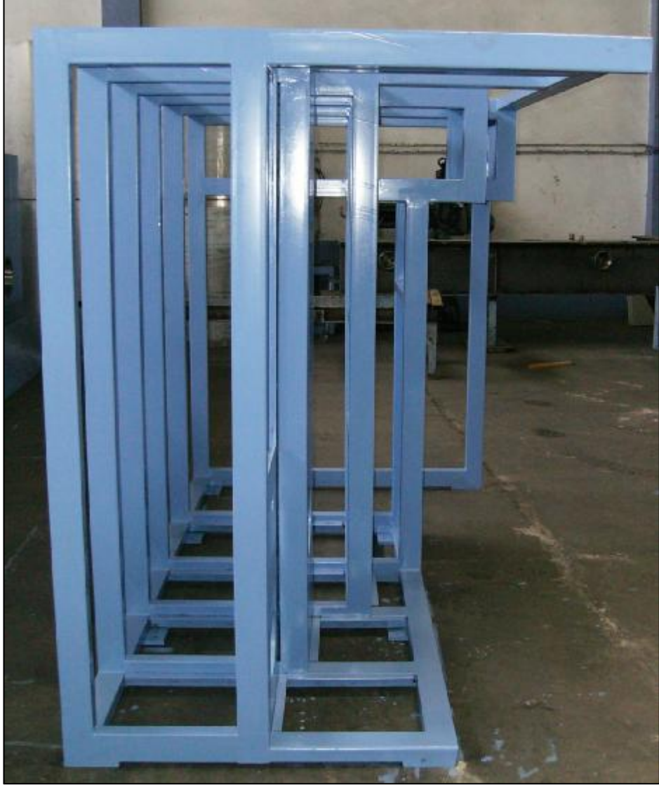
Şekil 3.3. Laboratuvar tipi filament iplik üretim makinesi şasesi yan görseli
