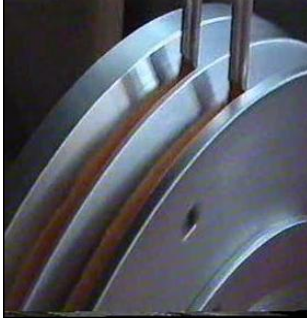
Şekil 3.12. Sürekli filament ipliğın tambur üzerine serimi (Uskaner, 2006)
