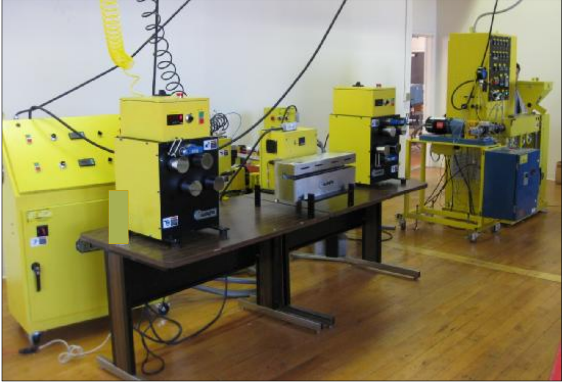
Şekil 1.5. Wayne Machine marka lab. tipi monofilament iplik üretim makinesi
