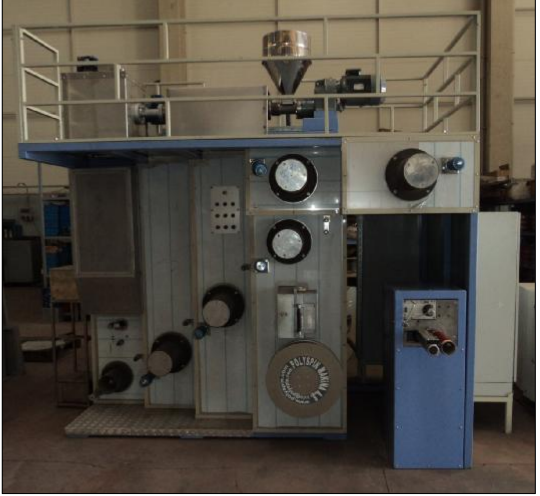
Şekil 3.6. Laboratuvar tipi filament iplik üretim makinesinin besleme hunisi, ekstrüder, yağ tankı ve sarım ünitesinin montajlarının tamamlanması
