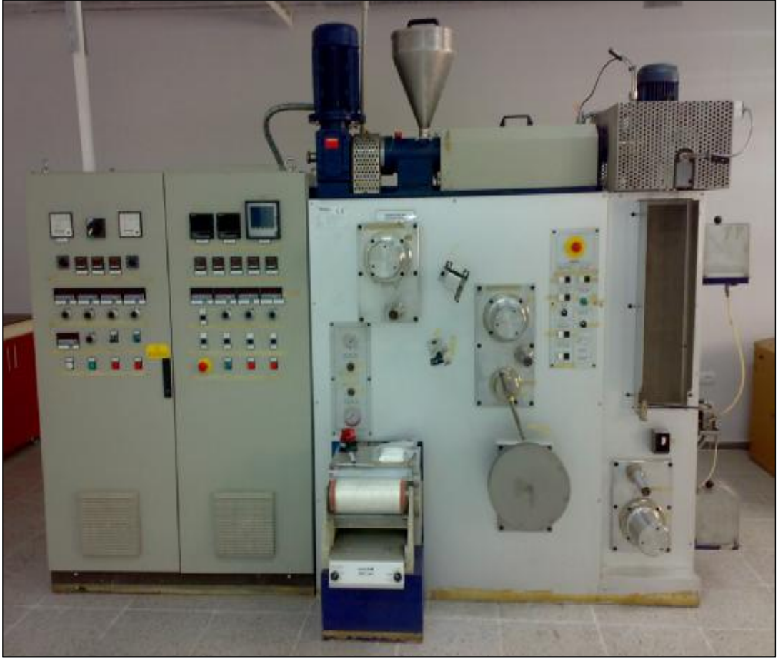
Şekil 1.6. Plantex Libe Line marka lab. tipi filament iplik üretim makinesi
