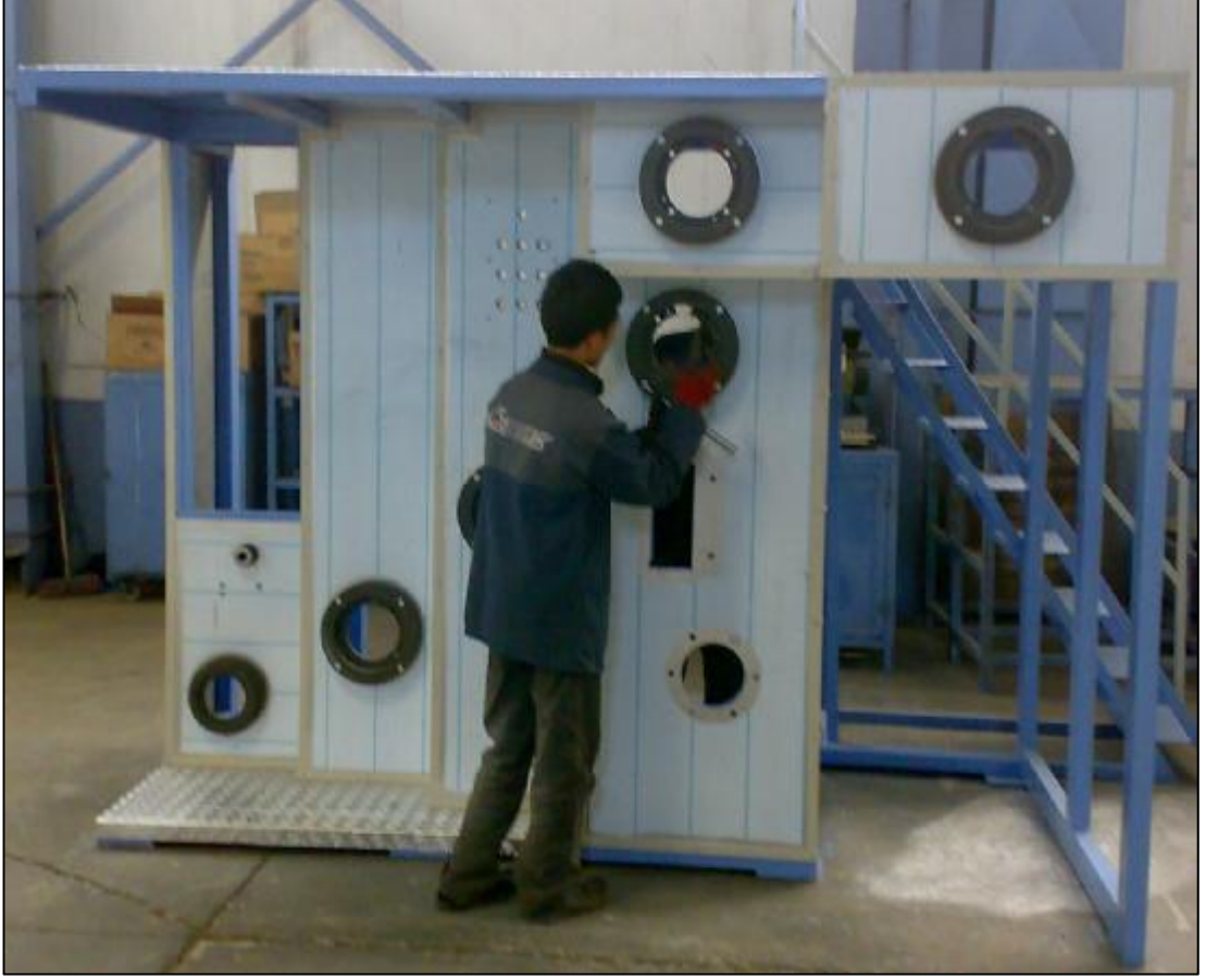
Şekil 3.4. Laboratuvar tipi filament iplik üretim makinesine godet yuvalarının açılması ve bağlantı elemanlarının montajı
