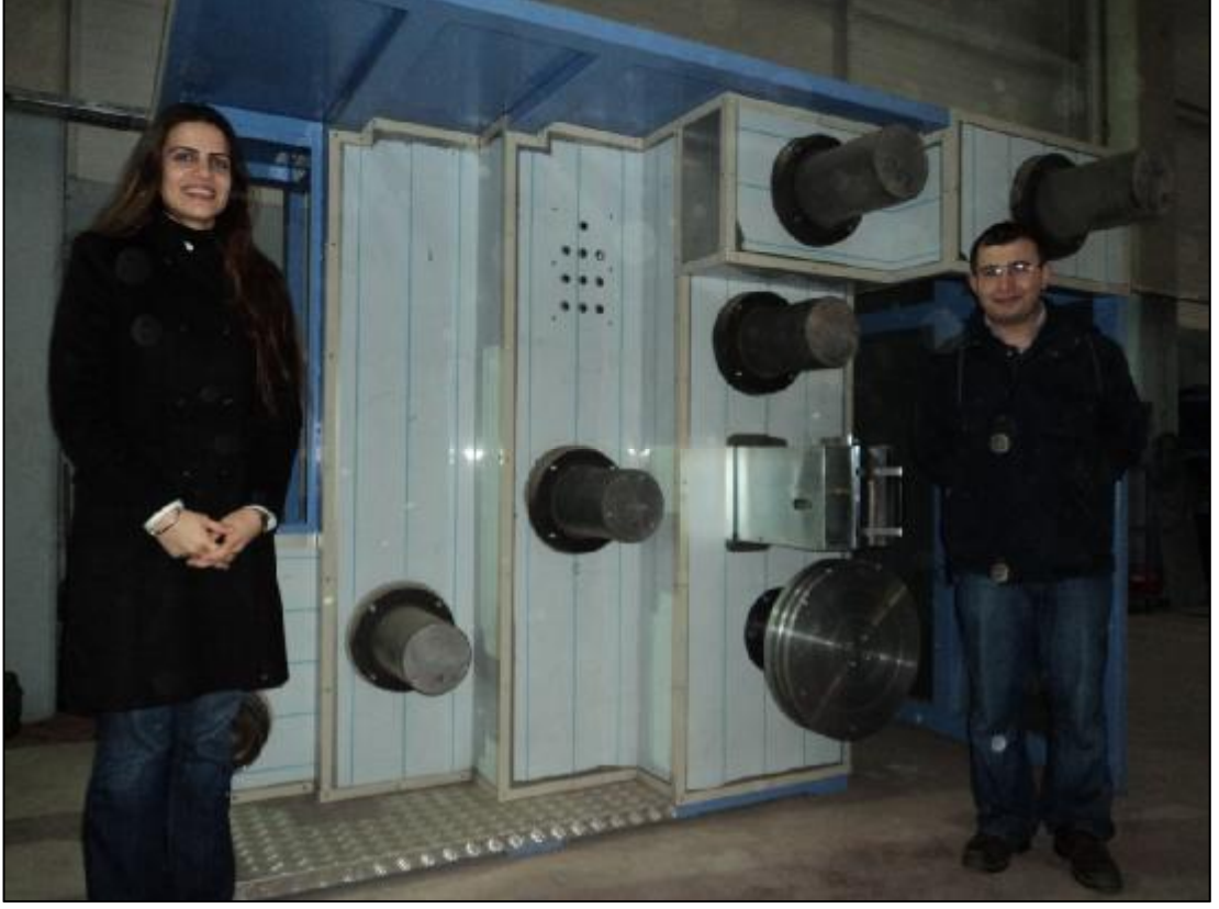
Şekil 3.5. Laboratuvar tipi filament iplik üretim makinesi godet ve tekstüre ünitesi montajlarının tamamlanması
