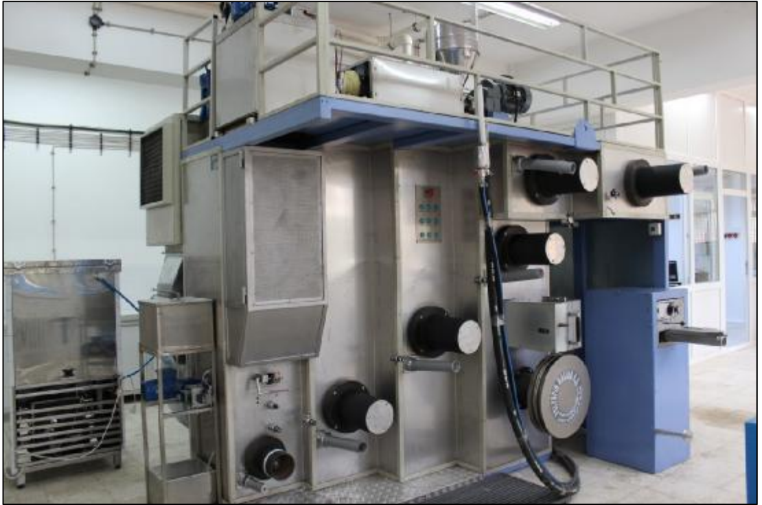
Şekil 3.8. İmalatı tamamlanmış laboratuvar tipi filament iplik üretim makinesi
